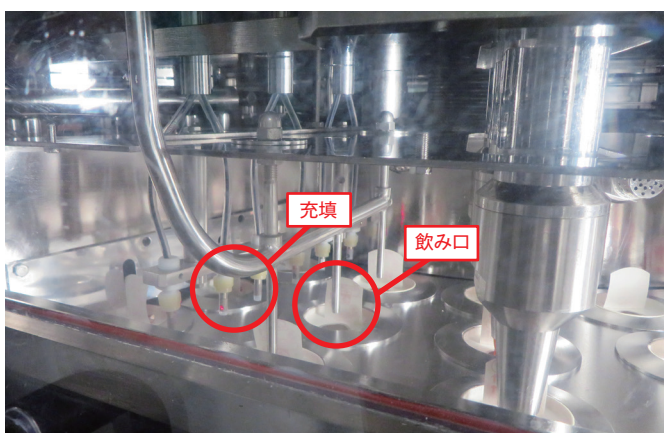
飲み口の形を読み取り、向きを揃えて充填することで高速充填に対応
