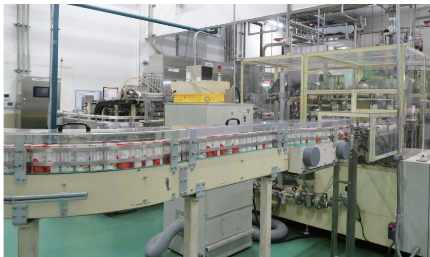
ライン上で充填に向かうカートカンの向きが統一されていく様子
